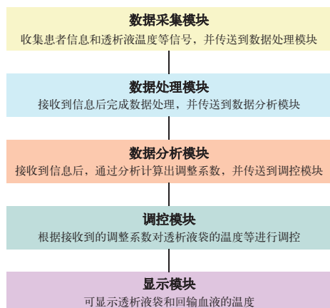
图 2 连续性肾脏替代治疗 (CRRT) 透析液袋加温保温装置中温控系统的工作原理
