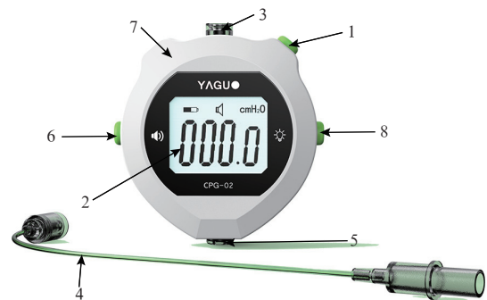
注: 1 为开关键, 2 为显示屏, 3 为测压鲁尔接头, 4 为延长管, 5 为充气接口, 6 为报警音开关, 7 为挂绳接口, 8 为背光键
